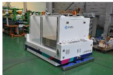
유한킴벌리 스크랩박스 이송용 AGV 1200 KG/ 자기유도
