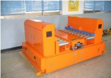
NONGSM 박스 이송용 AGV 600 KG/ 자기유도
