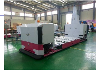
JAPAN NEG 팔레트 이송용 AGV 3000 KG/ LASER유도
