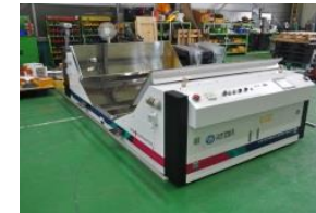
유한킴벌리 롤형태 제지 이송용 AGV 3000 KG/ 자기유도
