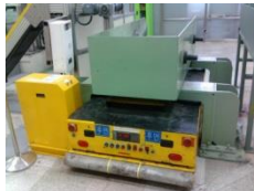
POSCO 스크랩박스 이송용 AGV 1200 KG/ 자기유도
